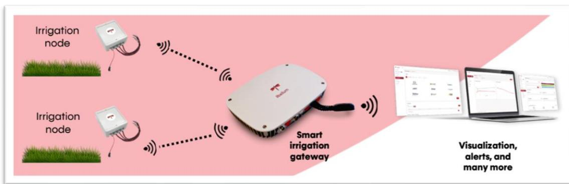
Solución de riego inteligente basada en una arquitectura de nodo maestro a través de LoRa. La comunicación bidireccional permite a los sistemas de riego actuar sobre electroválvulas y medir el volumen de agua a través de caudalímetros. Las principales aplicaciones de esta solución son Programación del riego, Fertirrigación, Control de enfermedades y plagas y Paisajismo y riego urbano.
