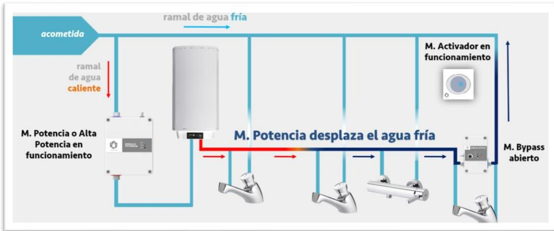
WAISENSE Comfort es un innovador dispositivo de ahorro, que ayudará a no desperdiciar litros de agua cada vez que se utiliza el agua caliente. Compuesto por un módulo de potencia, un bypass y un activador, puede ayudar a ahorrar hasta 25 litros por uso.
