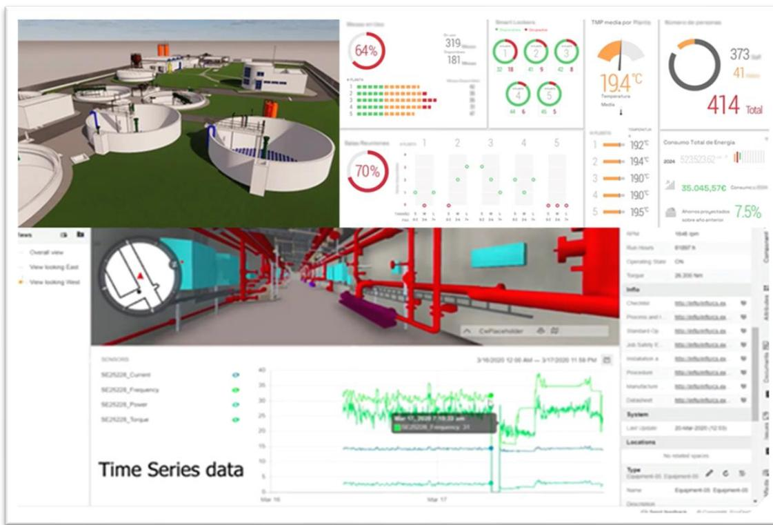
**TWIN PULSE.** Gemelo Digital de infraestructuras del sector agua. Permite reducir costes de O&M gracias a la digitalización, recogida y procesamiento de datos. Gemelo Digital Avanzado con una capa de Inteligencia Artificial que permite realizar mantenimiento predictivo y preventivo, reduciendo consumo energético, costes de material y tiempos de parada no programados.
